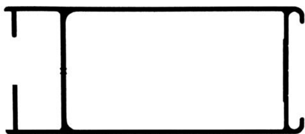
ALG 179 Parante puerta 36mm 0.970 kg/m
