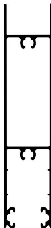
ALG M15 Zócalo alto DVH 1.200 kg/m
