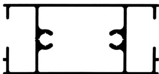
ALG 201 Travesaño puerta 36mm 1.045 kg/m
