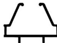
ALG N19 Vidrio repartido perimetral 0.239 kg/m
