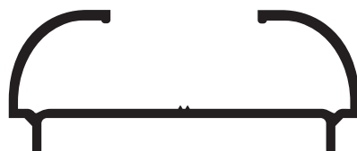
ALG 3104 Contravidrio DVH 22mm 0.409 kg/m
