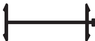
ALG 213 Perfil de acople 0.259 kg/m
