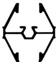
ALG N20 Vidrio repartido central 0.370 kg/m
