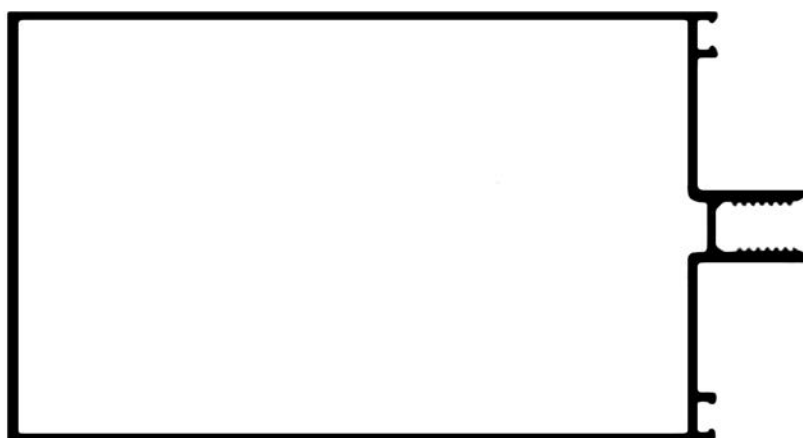
ALG 1403 Travesaño grande 1.548 kg/m
